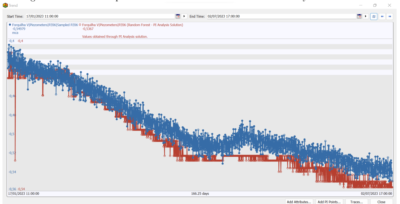
Figura 6.4: Valores Esperados X Valores Obtidos - PZE06 PI Analysis Solution
