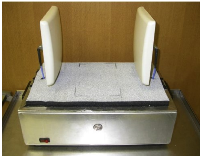
Figura 101 – Sensor do tipo micro-ondas onde o material se encontra entre as antenas.
