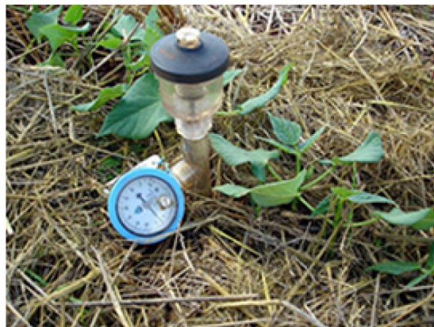
Figura 96 – Esquemático de um tensiômetro (a) equipamento em campo (b).
