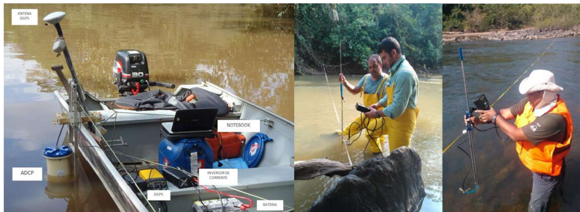
Figura 9 – Embarcação e equipamentos utilizados para medidas de vazão com ADCP (à esquerda) e com FlowTracker (à direita).
