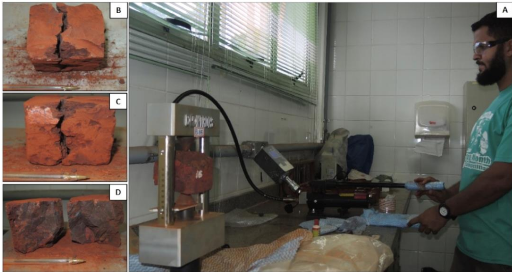
Figura 11 - Equipamento de ensaio PLT – A) Utilização do equipamento em laboratório; B, C e D) Ruptura válida em corpo de prova ensaiado.
