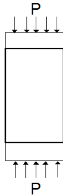
Figura 13 - Esquema de carregamento de um ensaio de resistência à compressão uniaxial.
