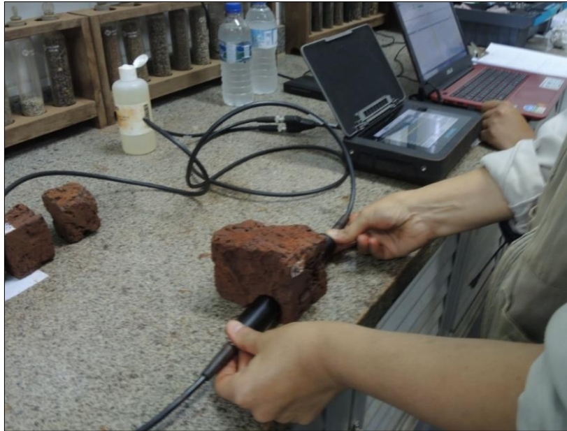
Figura 15 - Equipamento de Ultrassom Pundit PL 200 Pulse Echo e execução do ensaio de velocidade de propagação de ondas.
