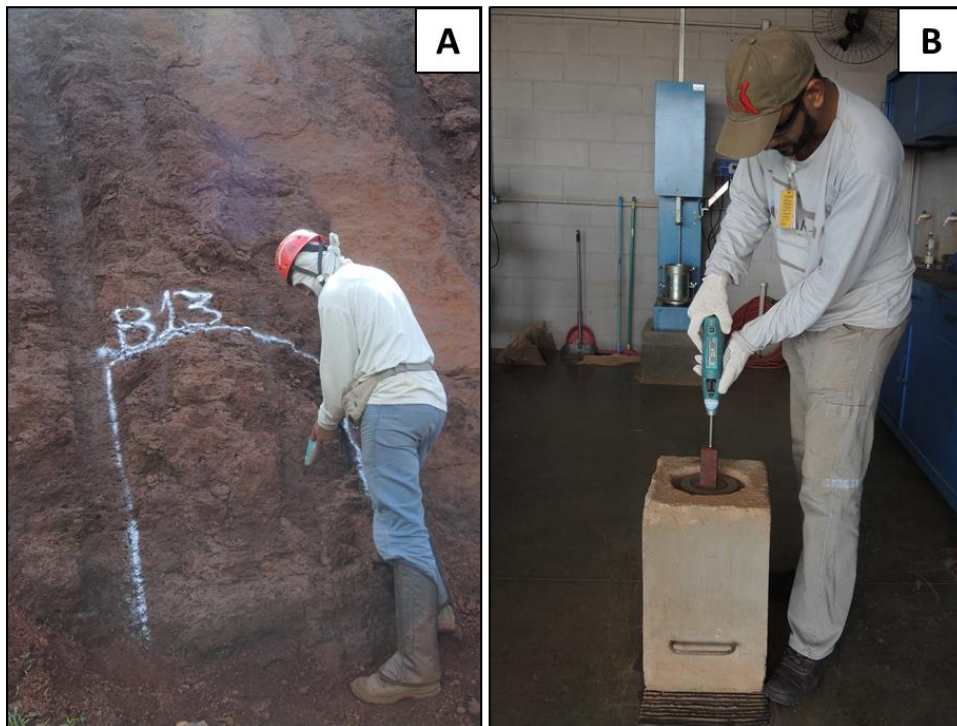
Figura 9 - Testes de dureza de Schmidt. (A) Teste realizado em janela de representação litomecânica (in situ); (B) Teste executado em corpo de prova (em laboratório).
